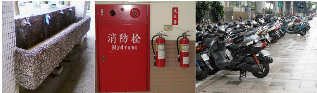
圖 1 懸空之障礙物—由右至左為洗手台、消防栓及機車檔泥板
