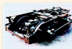
照片：阿里山鐵路動力轉向架《臺機半月刊》，1980年3月31日第三版。 資料來源：引用「傳動世紀-臺灣機械股份有限公司檔案專題選輯」
